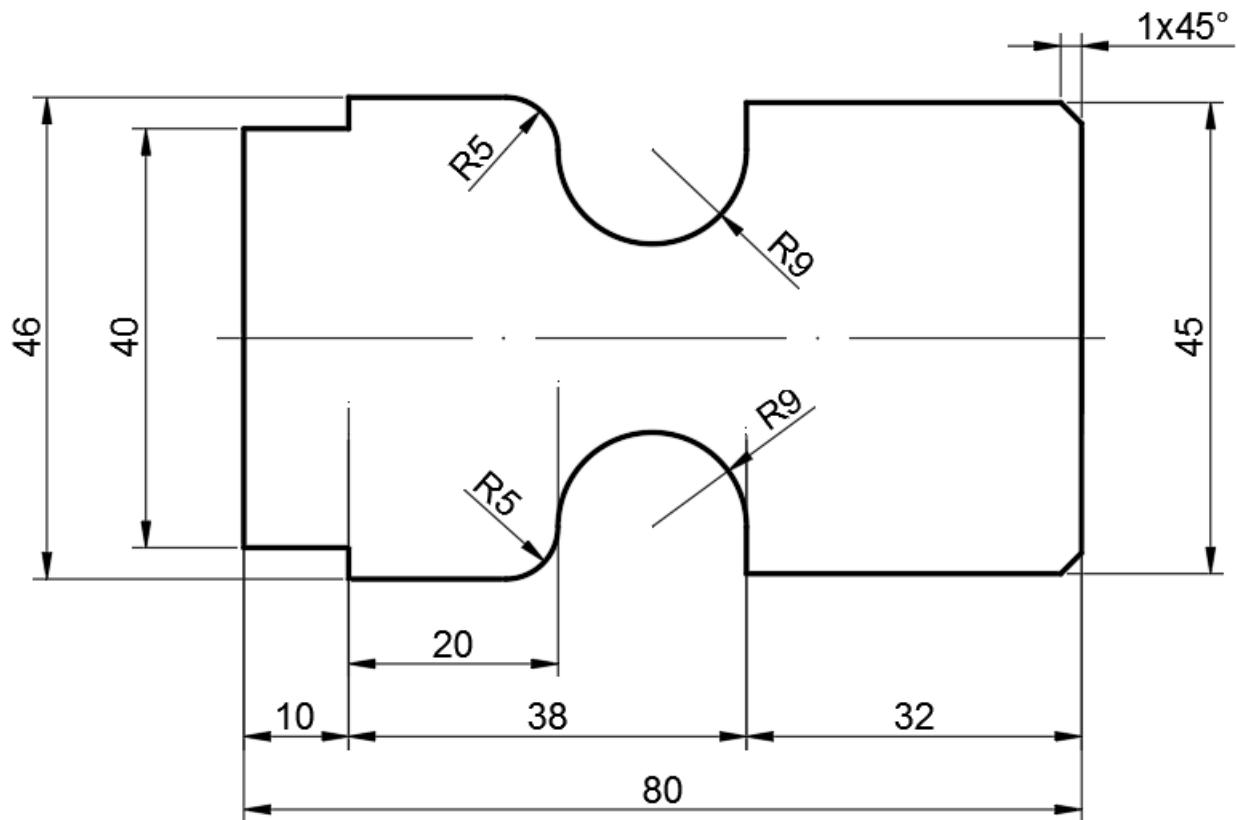
Рисунок 1 – Эскиз детали выполнен в масштабе 1 к 1
